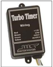
O Turbo Timer foi desenvolvido para manter o motor turbo do veículo ligado por aproximadamente 40 segundos depois de desligado a chave de ignição sendo que o produto só entra em funcionamento após o motor do veículo estar ligado por pelo menos 20 segundos caso contrário o produto não entrará em funcionamento.
